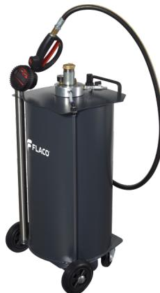
Ölspender mit 80-Liter-Druckbehälter. Lose Befüllung über Einfüllstutzen.
