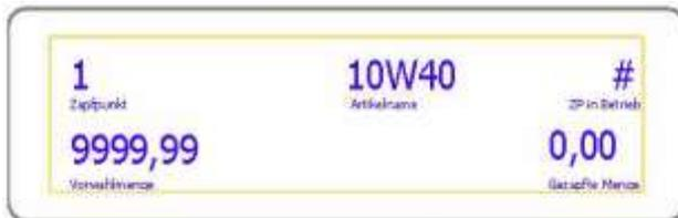
Mit dem Symbol # wird der Zapfpunkt der für die Fluidabgabe freigeschaltet ist angezeigt. Der Wert im Zähler wurde auf null zurückgesetzt. Die Abgabe kann begonnen werden. Während der laufenden Abgabe wird stetig die aktuelle entnommene Fluidmenge angezeigt. Mit Erreichen der Vorwahlmenge wird die Fluidabgabe beendet. Die entnommene Fluidmenge wird bis zur nächsten Freischaltung im Display angezeigt.
