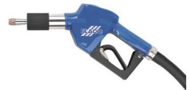
Um eine Fehlbetankung auszuschließen, wird die Pistole verwechslungssicher am AdBlue®-Einfüllstutzen (nach ISO 22241-5) adaptiert und freigegeben. Der speziell entwickelte Quad- Sensorkopf verhindert ein Überlaufen des Tanks. Eine integrierte Statusanzeige signalisiert wenn die Zapfpistole korrekt positioniert bzw. der Fahrzeugtank vollständig gefüllt ist.
